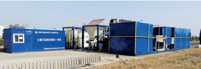
减量与淋洗一体化智能修复设备
